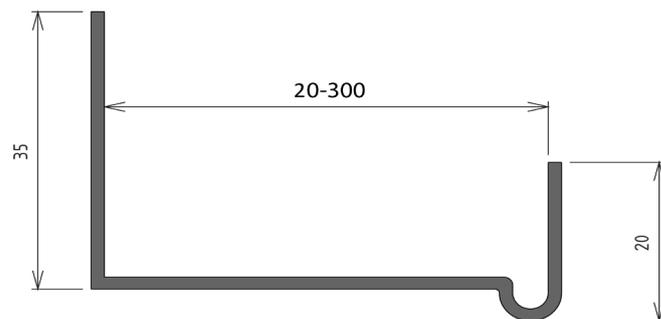
**PRODUIT :** Profilé de départ en aluminium perforé pour différentes épaisseurs d'isolant
